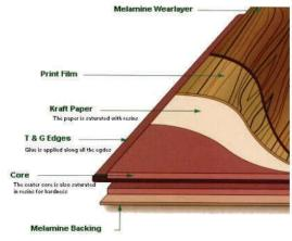
Il diagramma sopra riportato mostra una sezione di laminato per pavimento che rappresenta un buon esempio di 'laminazione di legno e plastica' così com'è definito dalla Direttiva. La resina melamminica è utilizzata come strato protettivo dei vari strati di legno. Al contrario nel processo FRP (foto sottostante) la resina bagna completamente la fibra di vetro per formare una struttura omogenea.
