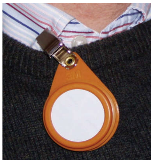
Uno de los sistemas más habituales son las placas de carbono activo, fabricados por varias empresas
