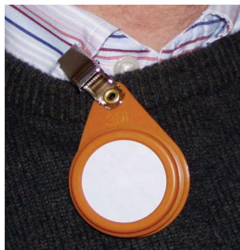
**Système de contrôle des badges et d'analyse des données pour enregistrer l'exposition au styrène sur le lieu de travail**
