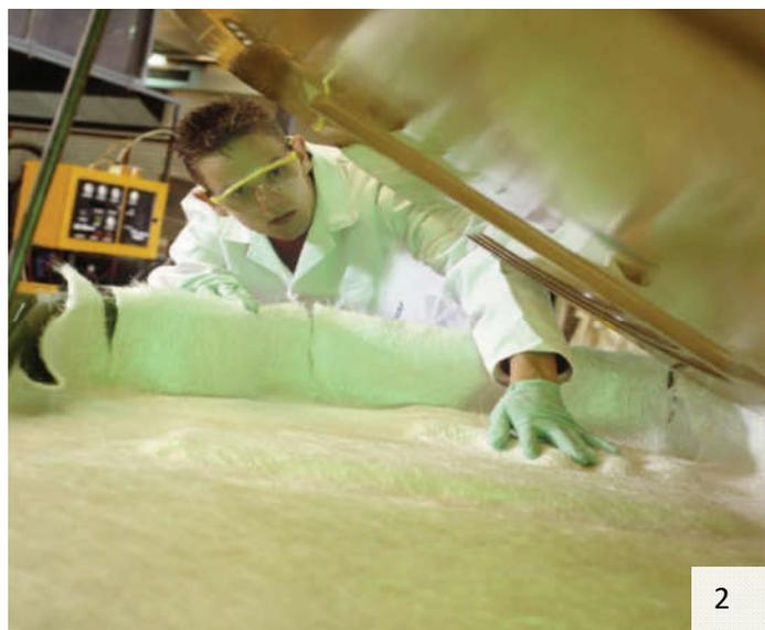
L'émission de styrène peut être considérablement réduite en adoptant des techniques de moulage en moule fermé, comme l'infusion de résine (1) ou l'injection de résine (2).
